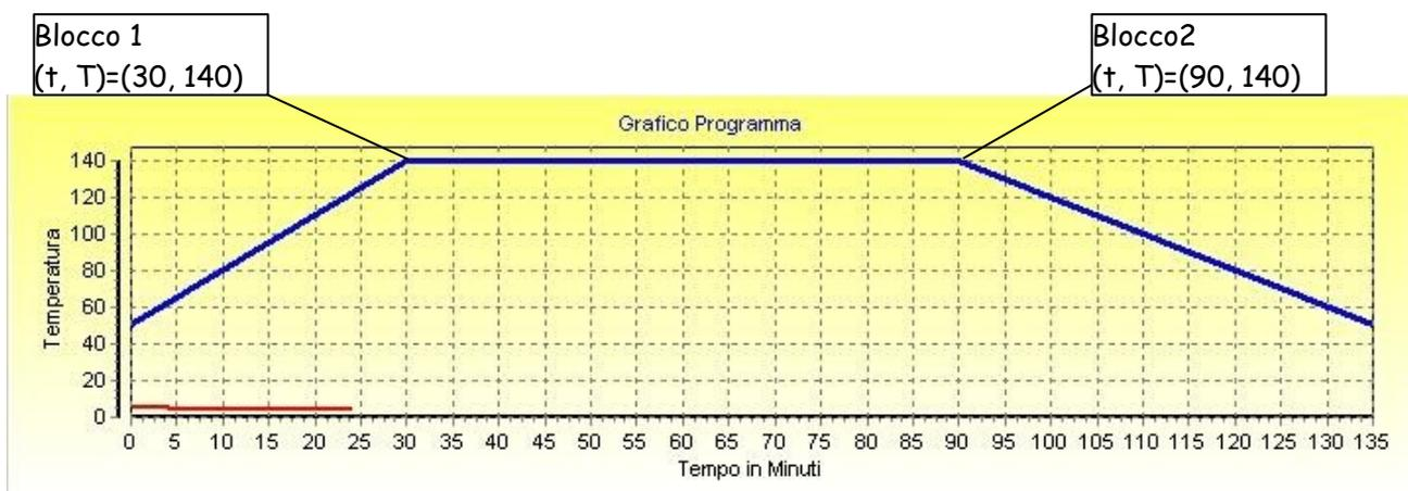
Fig.8 - Caratteristica del processo e definizione Blocchi
